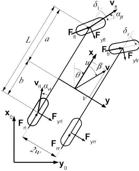
Fig. 2. System parameters
