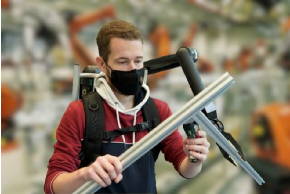
Vue d'un dispositif de membre surnuméraire robotique développé à l'ISIR.
